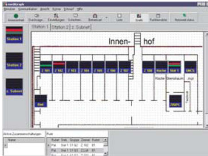
Le logiciel de supervision Medigraph permet de contrôler de manière centralisée le système d'appel malade et de visualiser sous forme graphique toutes les informations du système.
